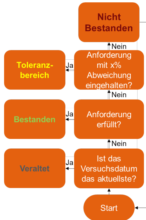
Abb. 3: Flussdiagramm für die automatisierte Ermittlung des Bearbeitungszustands eines Versuchspunkts
